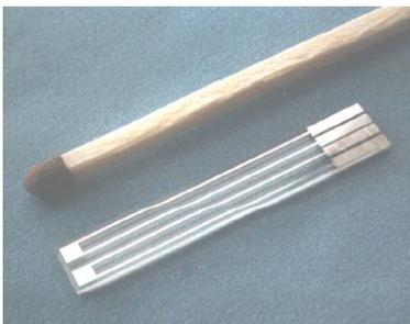
Figure 20 : Photo d'un microcapteur conductimétrique
